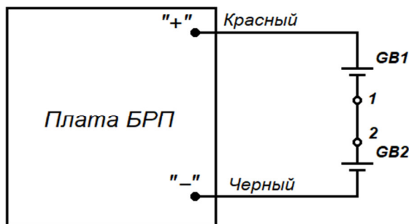
Рисунок 3 - Схема соединения АКБ с платой БРП
